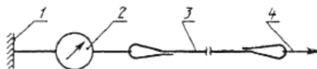
1 – жесткая опора; 2 – измеритель усилия; 3 – строп или другой элемент пояса; 4 – растягивающее усилие
